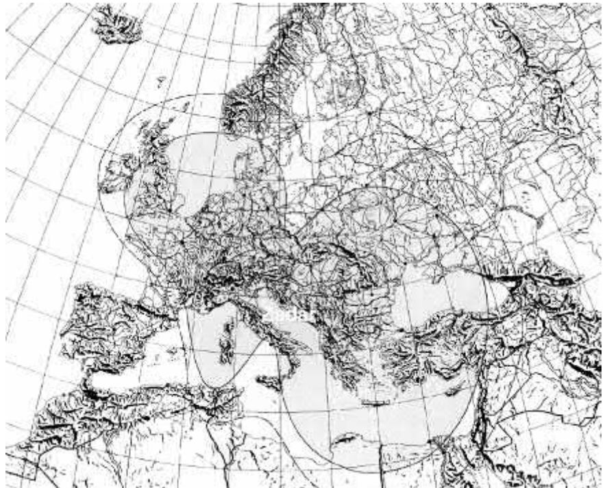
Sl. 1 Loše pokrivanje Europe uvečer srednjim valom 1134 kHz nakon rekonstrukcije antene odašiljača Zadar na 4 stupa. Previše energije ide u Jonsko i Crno more, na uštrb sjevernih zemalja. (Izvor: RTV Zagreb, 1985)
